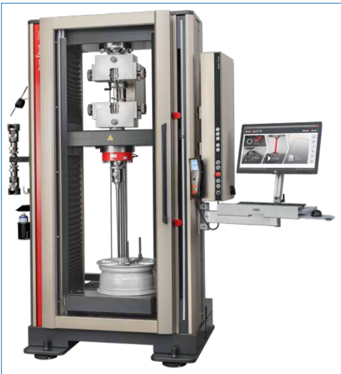
Zugprüfmaschine von Zwick Z-250 mit max. 250 kN.
